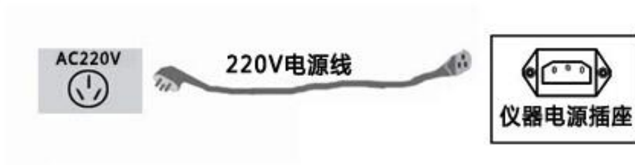
图 1.1 仪器 AC220V 电源供电接线图
