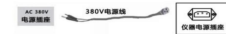
图 1.2 仪器 AC380V 电源供电接线图
