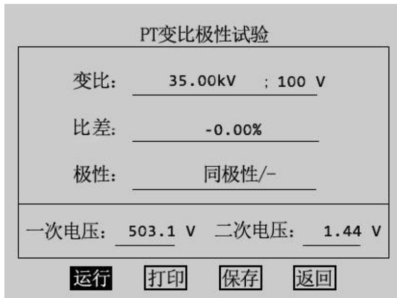
图 4.5 PT 变比极性试验结果
