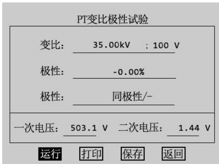
图 7.6 PT 变比极性试验结果
